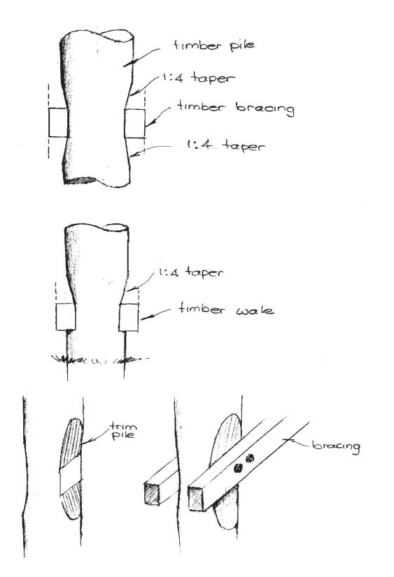
Figure 7.7(d) - End Protection
