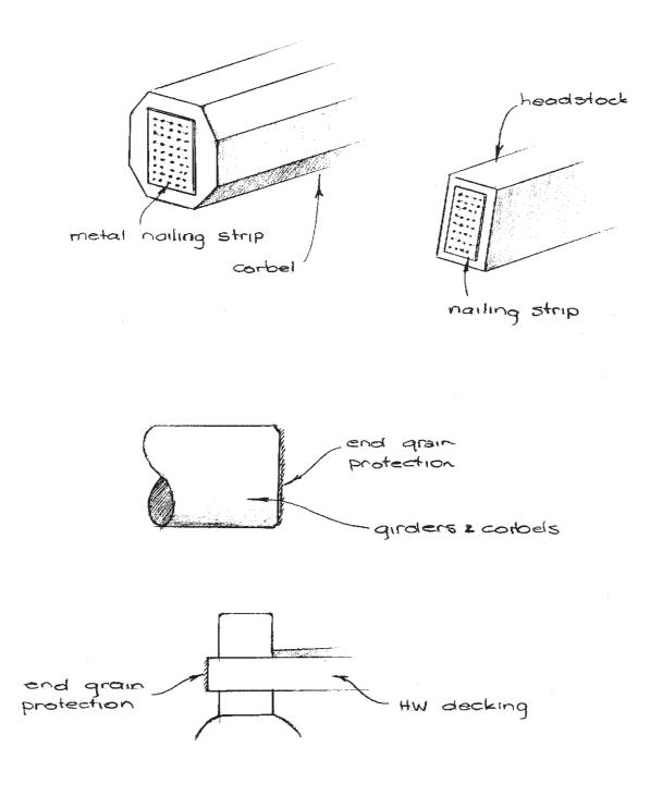
Figure 7.7(d) - End Protection
