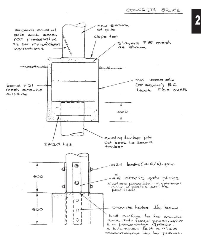
Figure 11.1(d) - Concrete Splice
