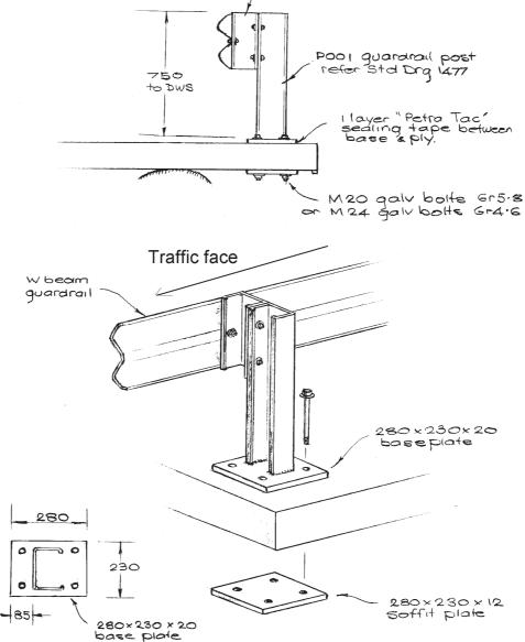
Figure 3.2(d) - Barrier - Ply Deck
