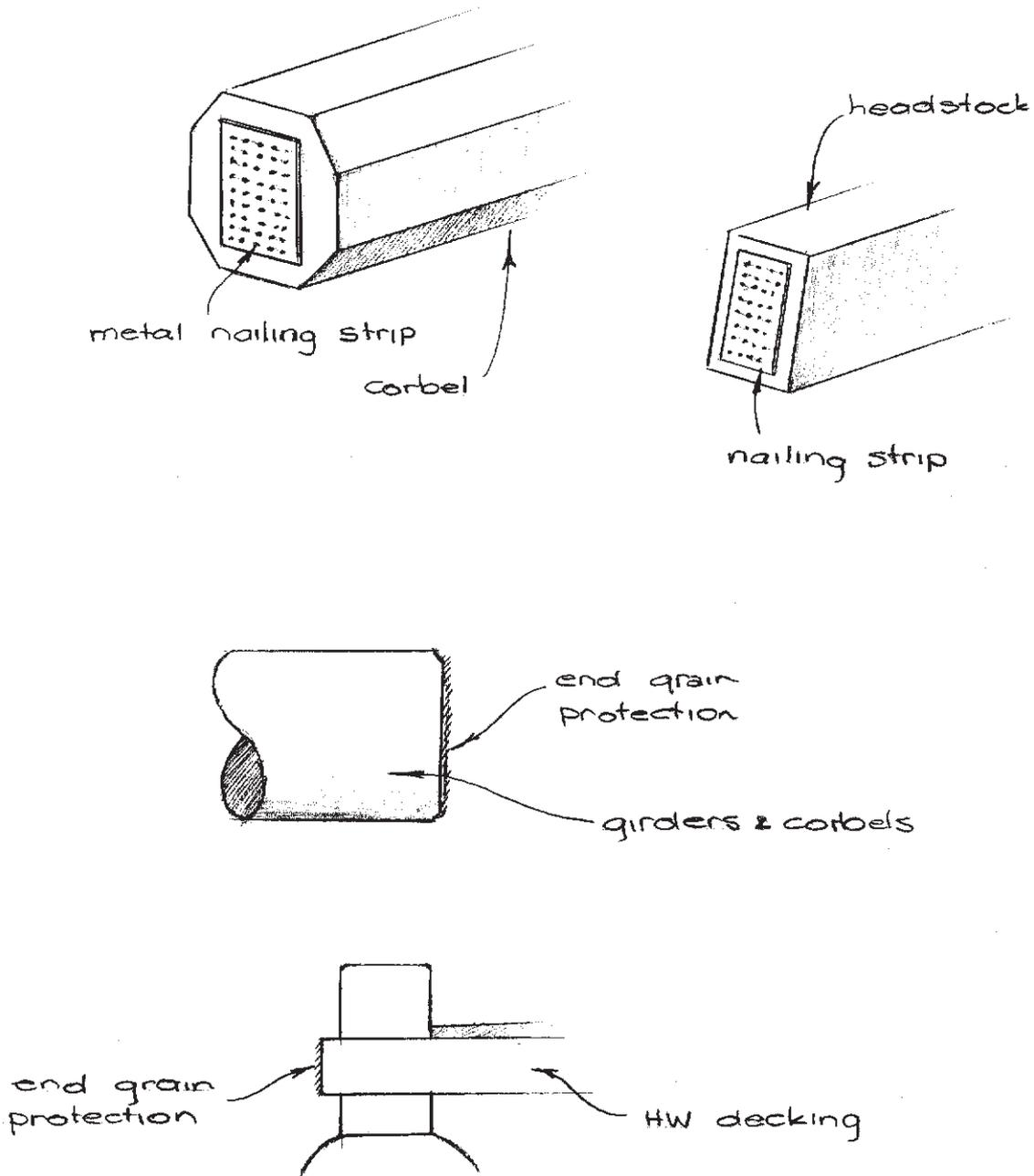
Figure 7.7(d) - End Protection
