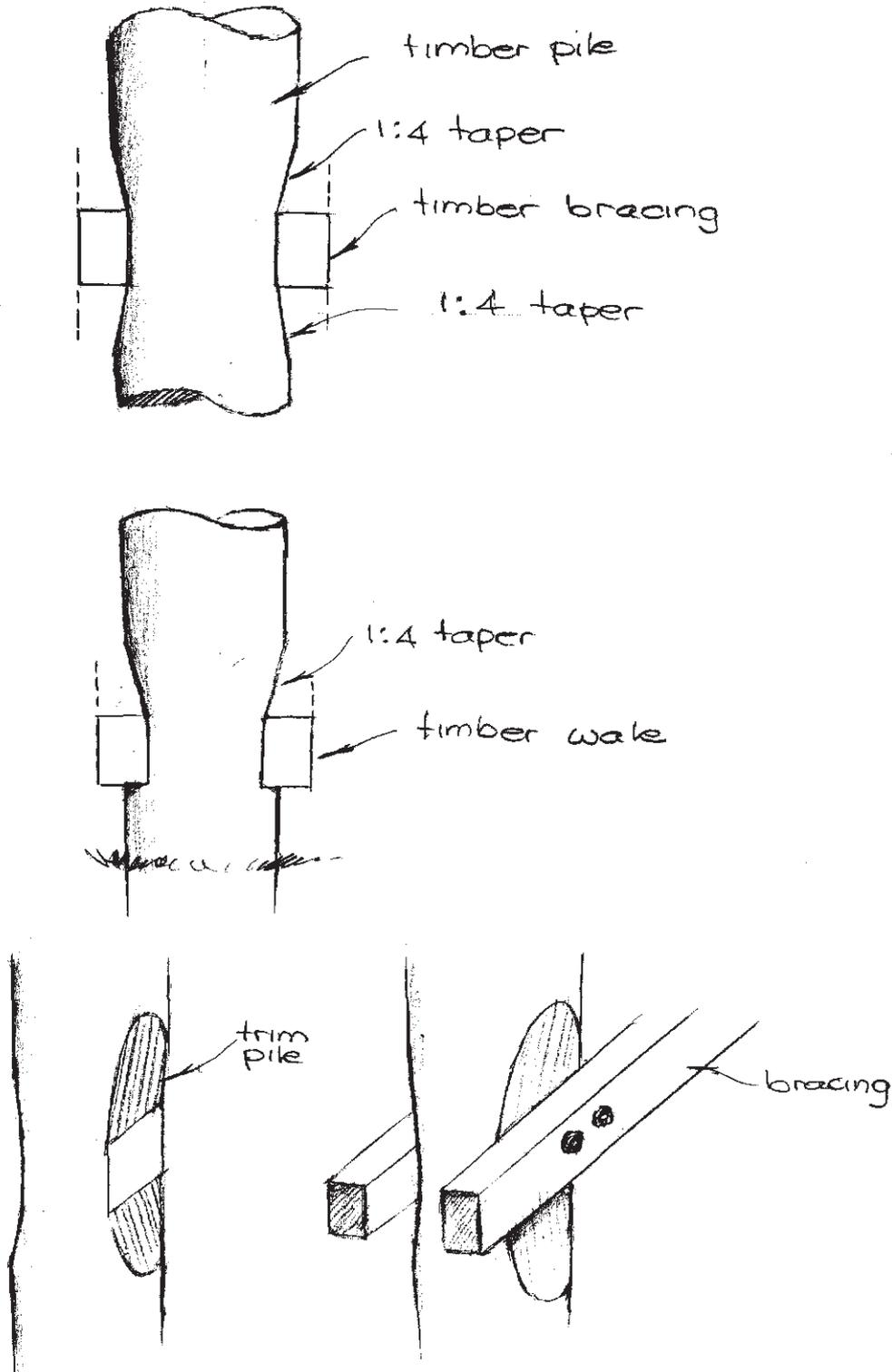
Figure 7.7(d) - End Protection
