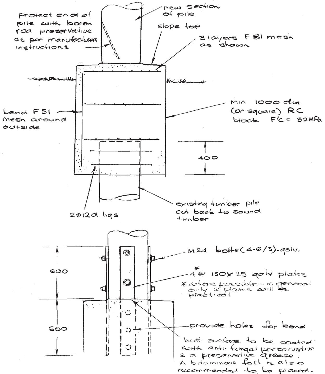
Figure 11.1(d) - Concrete Splice
