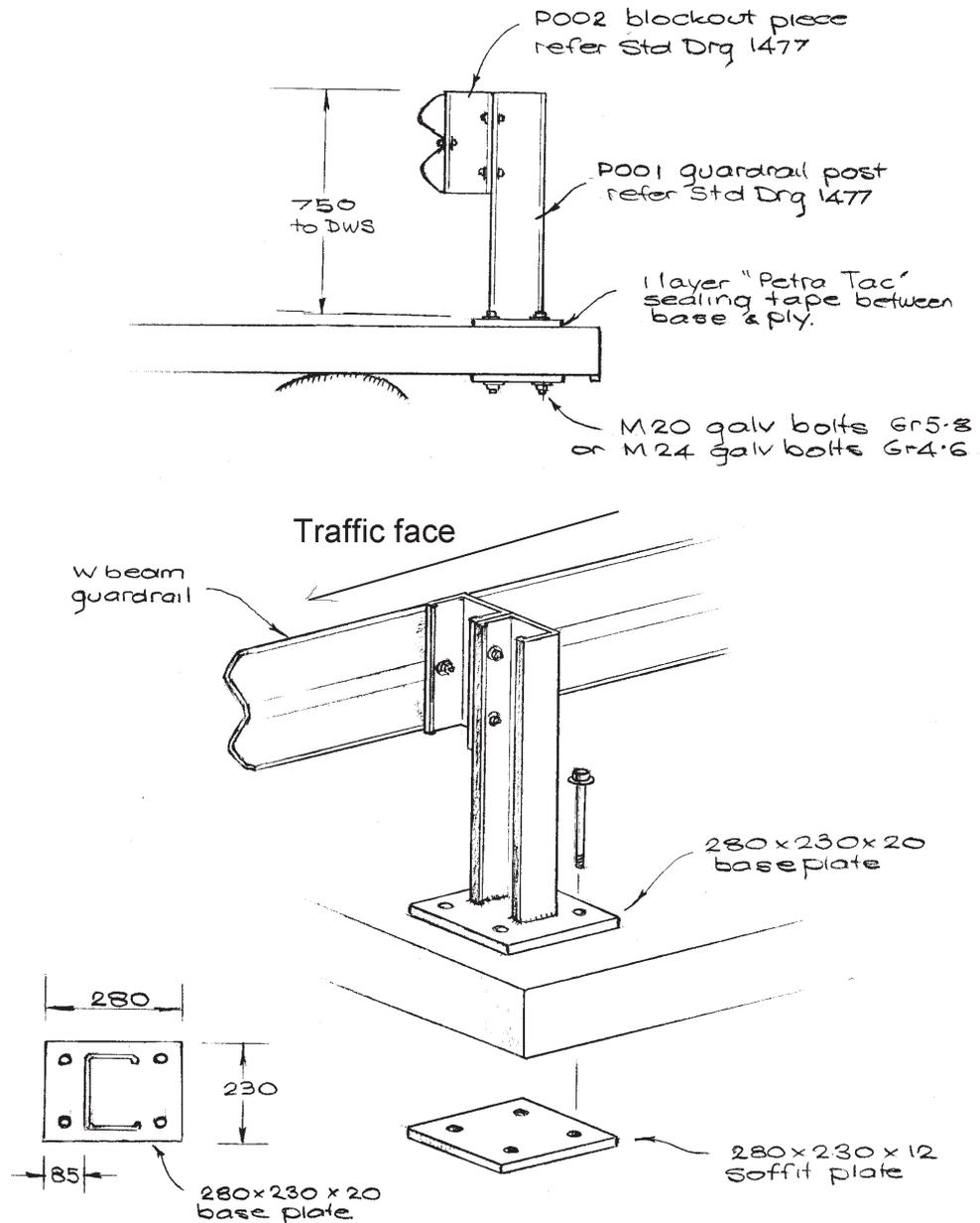
Figure 3.2(d) - Barrier - Ply Deck
