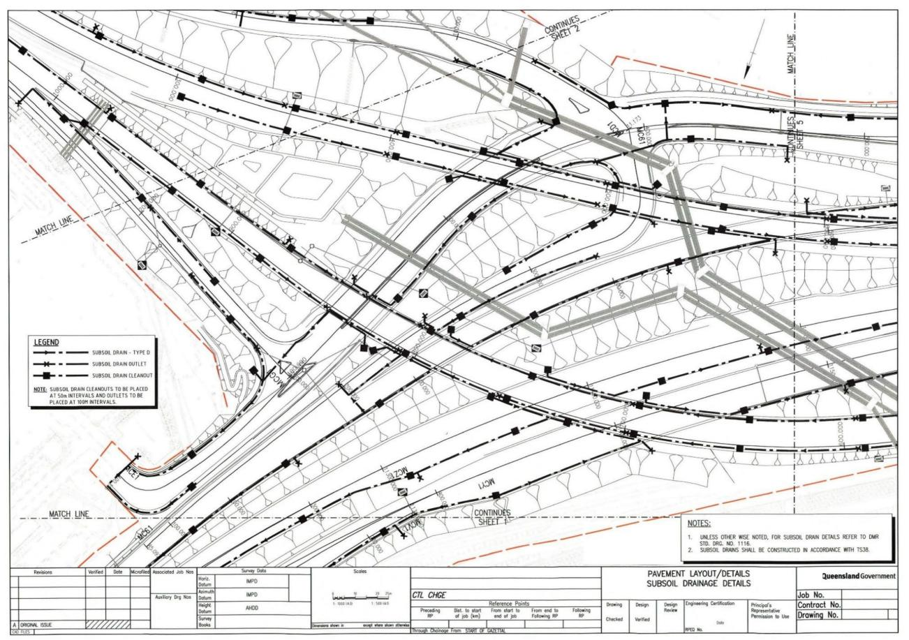
Figure 2.11.1(d) - Drainage layout - registered example 1
