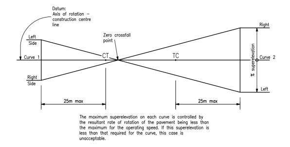
Case 3B: REVERSE CIRCULAR CURVES WITH SPACING < SPACING FOR Case 4
